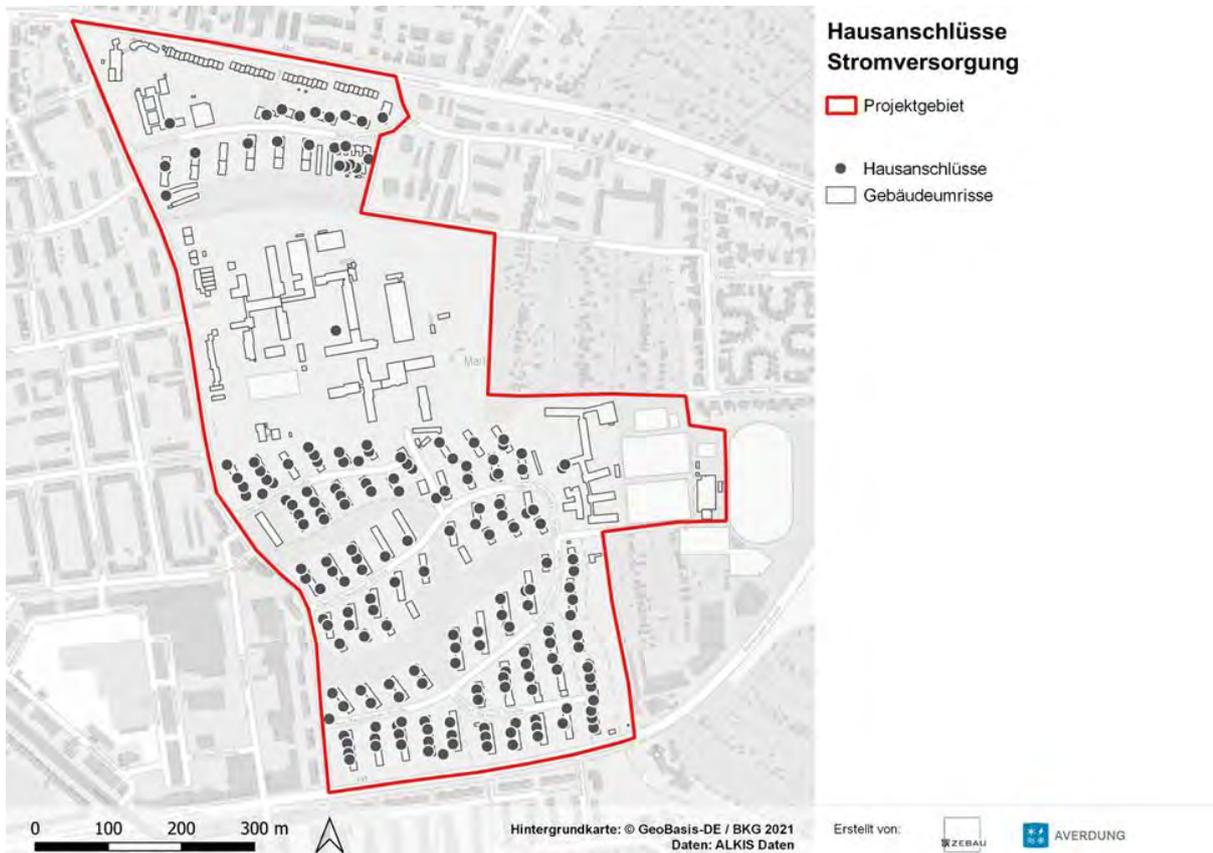
Abbildung 19: Hausanschlüsse zur Stromversorgung
